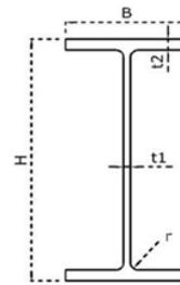
Gambar 1. Profil Baja *Wide Flange*.
