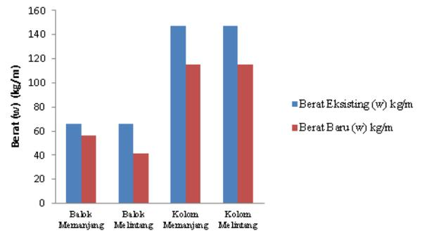
Gambar 11 Diagram Perbandingan Berat (w) pada Balok dan Kolom Memanjang serta Melintang Profil Eksisting dan Profil Baru
