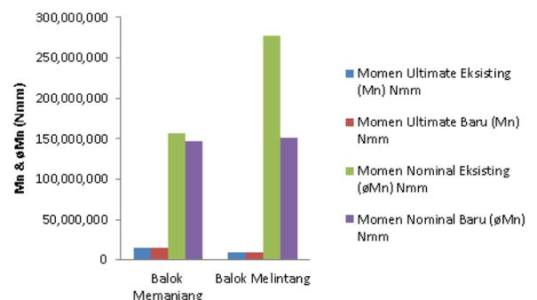
Gambar 12 Diagram Perbandingan Momen Ultimate (Mu) dan Momen Nominal (oMn) pada Balok Memanjang serta Melintang Profil Eksisting dan Profil Baru
