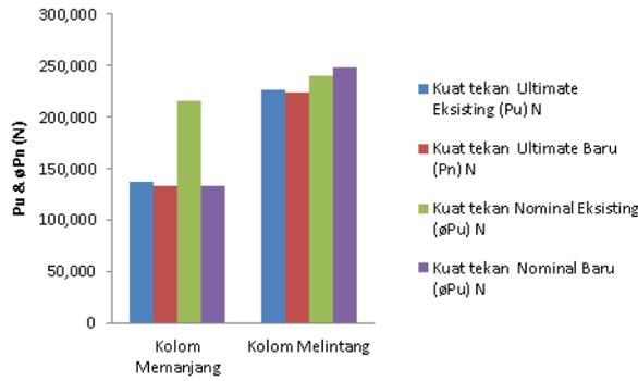
Gambar 13 Diagram Perbandingan kuat tekan Ultimate (Pu) dan kuat tekan Nominal (øPu) pada Kolom Memanjang serta Melintang
