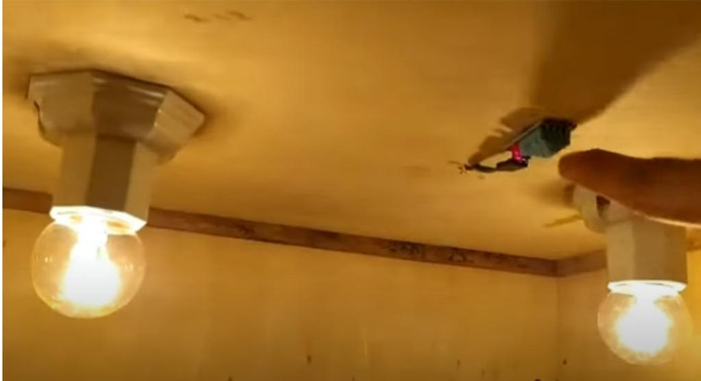
Gambar 4.3 Sensor suhu yang diletakkan di langit-langit mesin penetas telur
