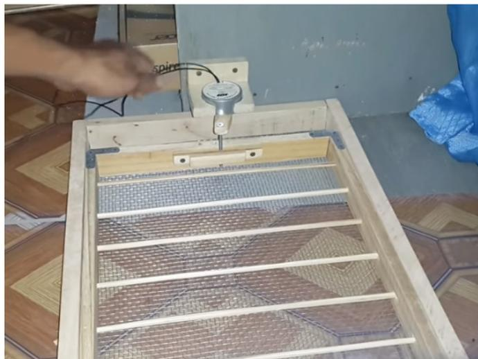
Gambar 4.2 Rak untuk memutar telur itik.
