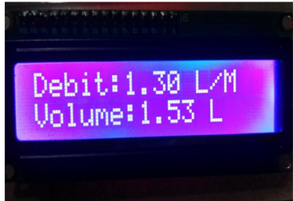
Gambar 12 Hasil Pengujian Menggunakan Sample Air 1.5L
