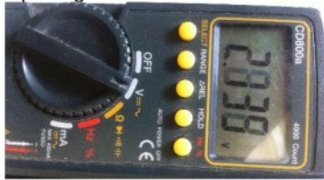
Gambar 10 hasil ukur tegangan keluaran waterflow
