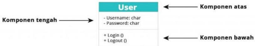
Gambar 37. Komponen Penyusun Class Diagram
