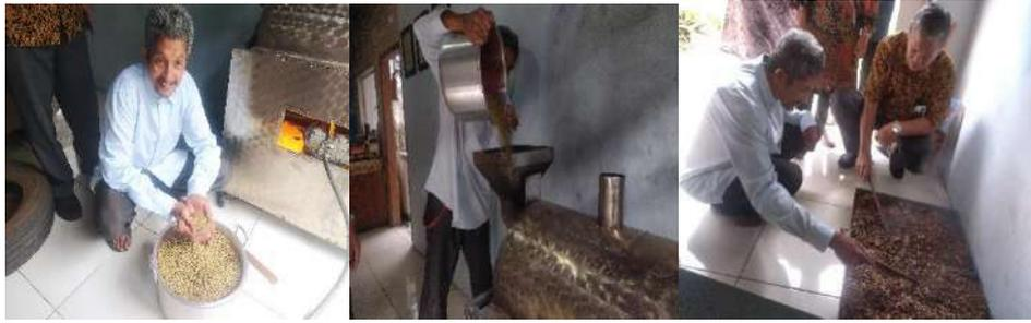
Gambar 4.2 Mitra Belum Menggunakan APD Saat Proses Produksi Kopi
