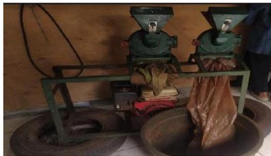
Gambar 1.8 Mesin Penggiling Biji Kopi Setelah dari Mesin Rosting
