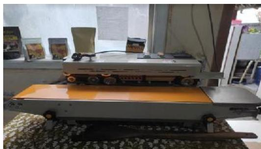
Gambar 1.9 Mesin Sealer untuk Pengemasan Kopi
