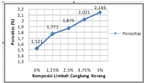
Gambar 4. Porositas Benda Uji pada Umur 28 Hari
